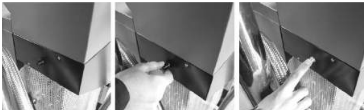
Рис. 17: Включение термического предохранителя
