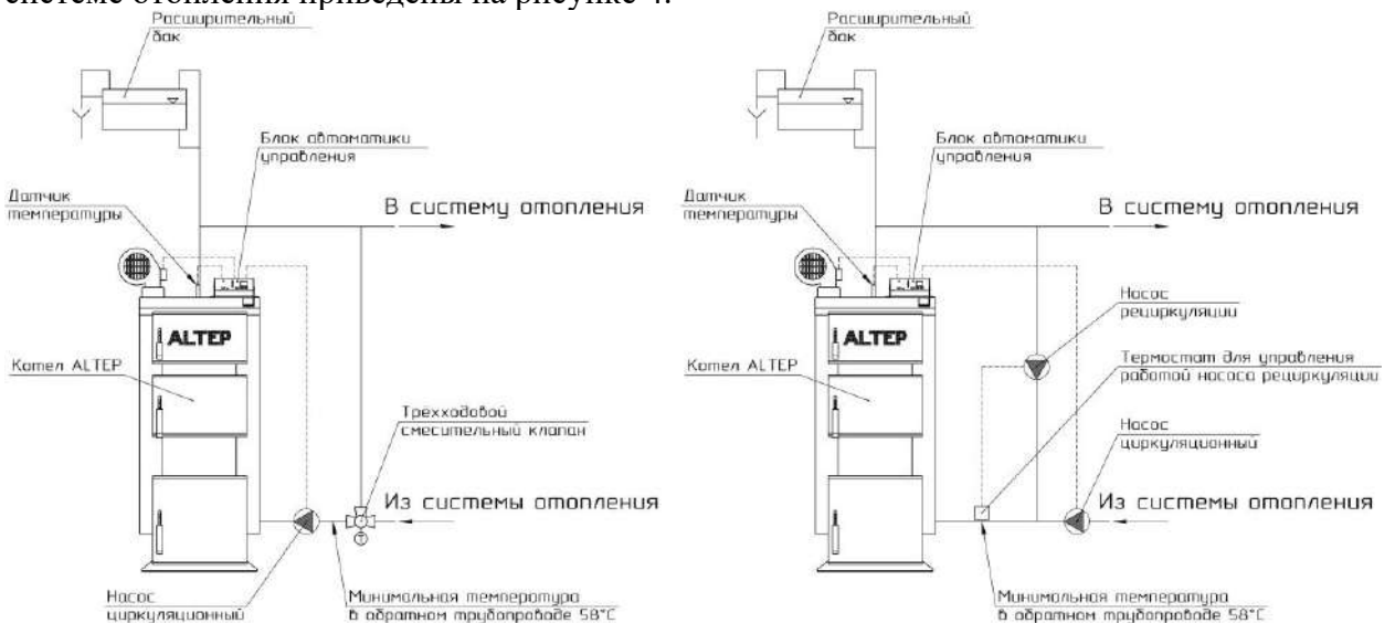
Рисунок 4 - Схемы подключения котла к системе отопления
