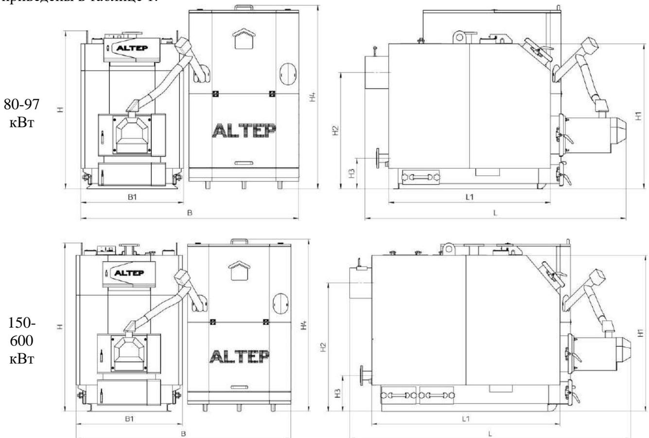
Рисунок 1 - Габаритный чертеж котла типа КТ-3Е-РG
