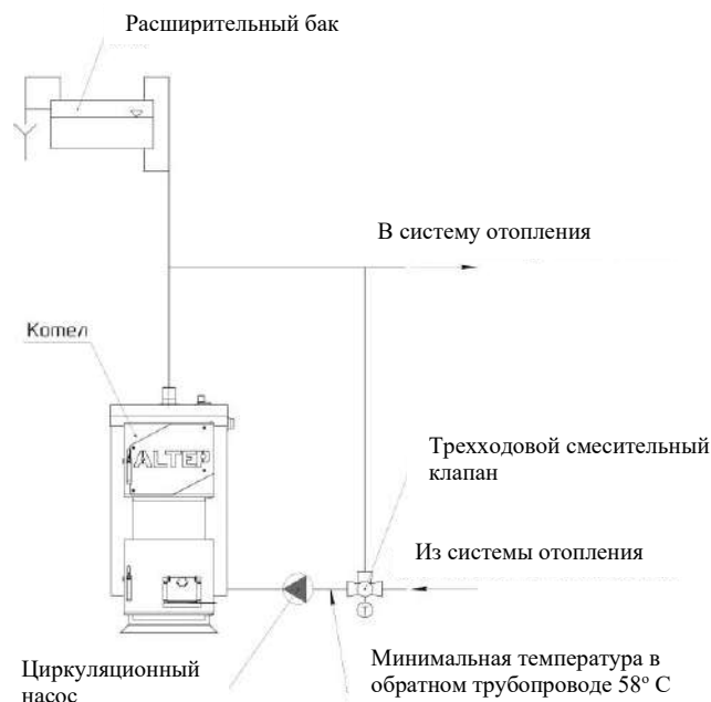
Рисунок 3 - Схемы подключения котла к системе отопления
