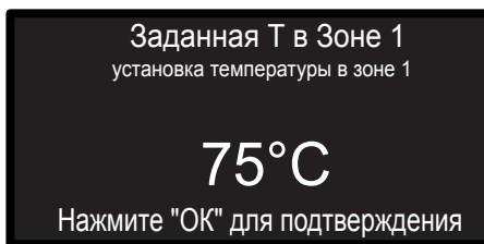
Изменение температуры горячей воды отопления
