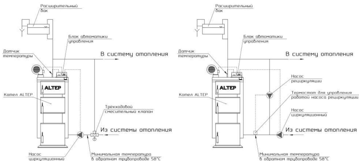
**ВНИМАНИЕ!** При подключении котла к системе отопления с естественной циркуляцией теплоносителя, необходимо смонтировать дополнительный предохранительный клапан на трубопроводе прямой сетевой воды в непосредственной близости от котла. Дополнительный клапан должен быть полностью аналогичный основному предохранительному клапану, установленному на котле.
