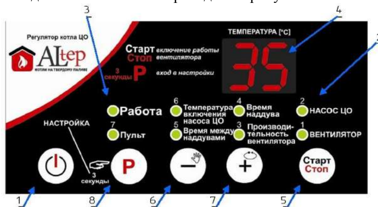
Рисунок 3 - Внешний вид передней панели контроллера
