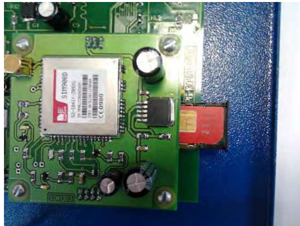
Фото 12.1. Установка лотка на место
