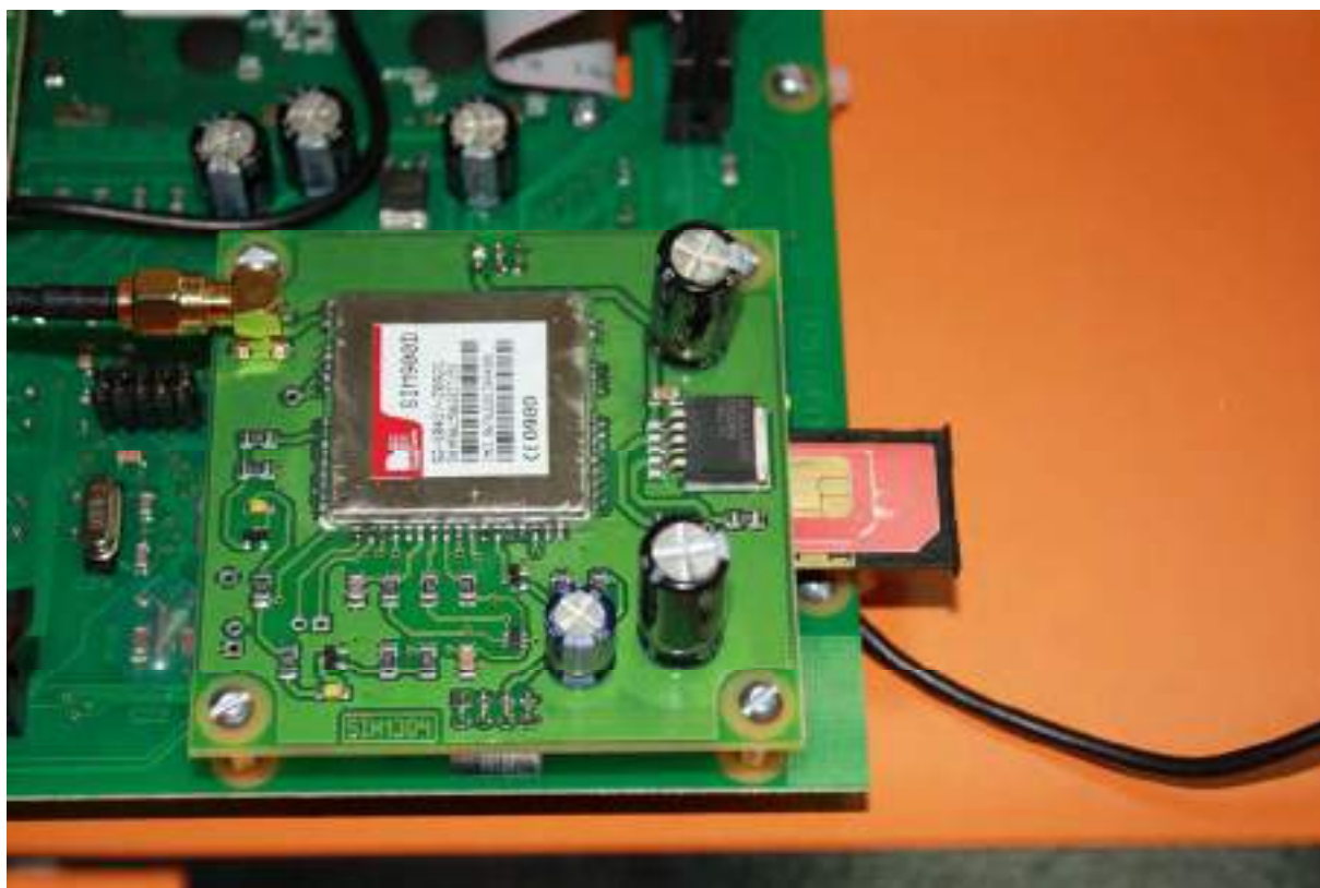
Рис.17.1. Установка лотка на место.
