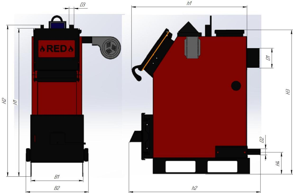
Рисунок 1 — Схема для таблицы размеров котлов RED
