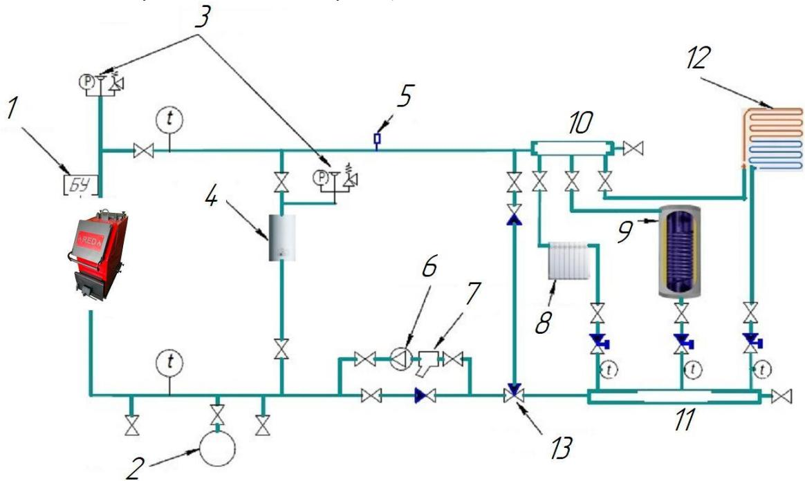
*Рисунок 5 – Схема обвязки котла с трехходовым клапаном. 1-блок управления котлом; 2-расширительный бак; 3-группа безопасности; 4-электрокомпенсатор резервный; 5-воздухоотводчик; 6-насос циркуляционный; 7-фильтр; 8-радиатор; 9-бойлер; 10-коллектор подачи; 11-коллектор обратной подачи; 12-теплый пол; 13-клапан трехходовой.*
