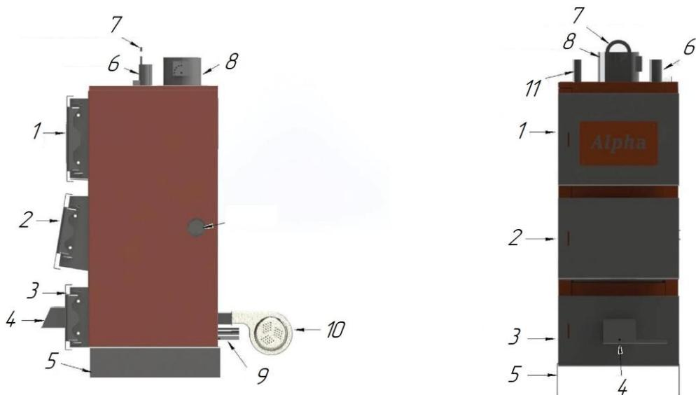
*Рисунок 3 — Схема котла ALPHA. 1-дверь верхняя; 2-дверь средняя; 3-дверь нижняя; 4-окно поддува; 5-опора котла; 6-труба подачи; 7-ухо транспортировочное; 8-дымовая труба; 9-труба обратной линии; 10-вентилятор наддува; 11-патрубок группы безопасности*
