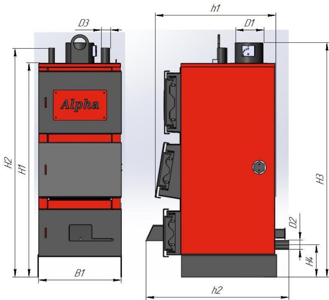
Рисунок 1 — Схема для таблицы размеров котлов ALPHA
