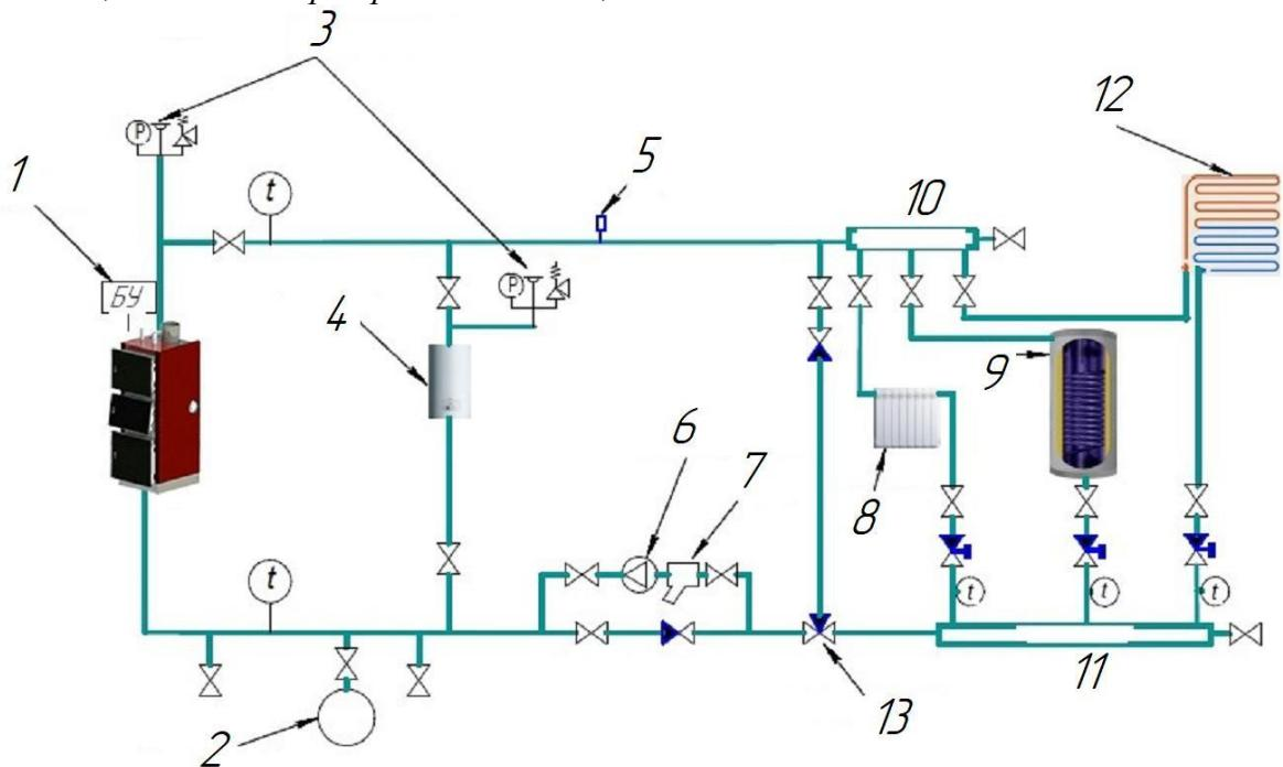
Рисунок 6 – Схема обвязки котла с трехходовым клапаном. 1-блок управления котлом; 2-расширительный бак; 3-группа безопасности; 4-электрокотел резервный; 5-воздухоотводчик; 6-насос циркуляционный; 7-фильтр; 8-радиатор; 9-бойлер; 10-коллекtor подачи; 11-коллекtor обратной подачи; 12-теплый пол; 13-клапан трехходовой.
