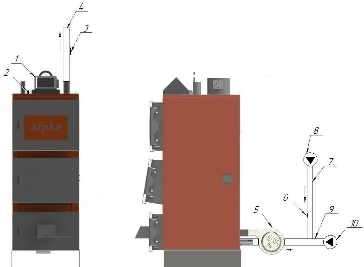
*Рисунок 8 — Схема подключения блока управления к котлу. 1-контроллер (подключается к сети 220В; 2-датчик системы отопления (устанавливается в гильзу); 3-аварийный датчик (термик); 4-труба подачи; 5-вентилятор; 6-датчик горячего водоснабжения (ГВС); 7-труба обратной подачи от бойлера ГВС; 8-насос ГВС; 9-труба обратной подачи от отопления; 10-насос системы отопления.*
