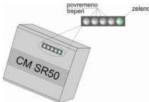
Датчик наполнения при нормальной работе (горит одна зеленая ЛЕД диода, а остальные мигают в зависимости от количества пеллет, которые падают по трубке подачи)
