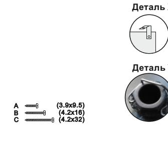
1. Прикрепите держатели изоляции (8) винтами 4,2x16 в отверстия на верхней стороне корпуса котла.
