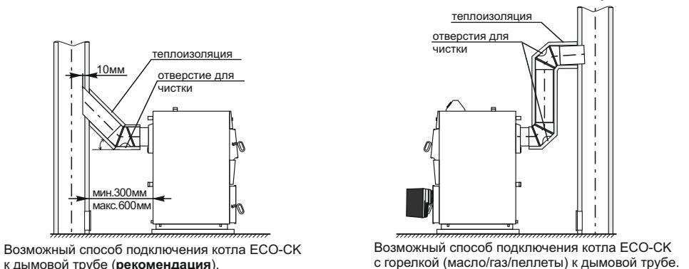
**Рис. 4. -** Размеры дымовой трубы для котла ECO-СК
