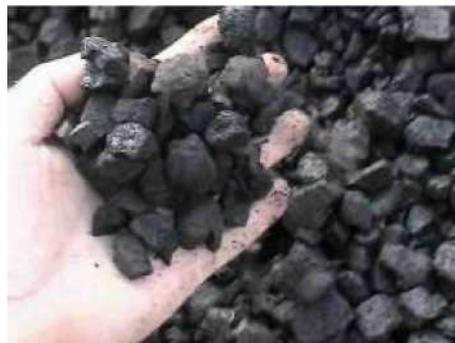
Применение крупнозернистого угля, т.е. размерами больше от указанных приводит к снижению достигаемой мощности, к остыванию дымовых газов, а в последствии к преждевременной коррозии котла.
