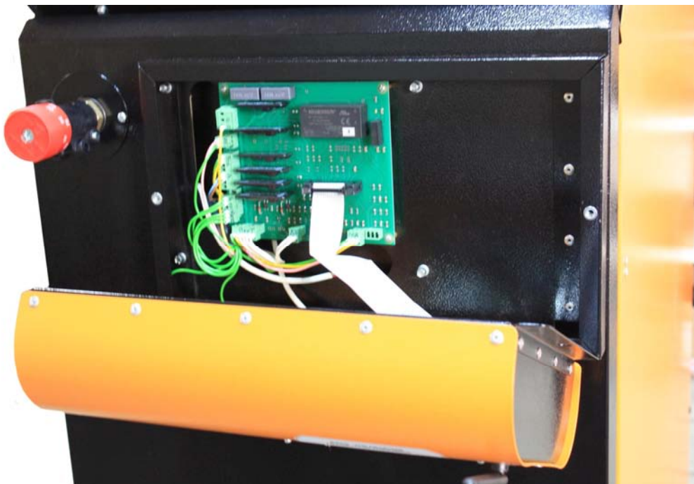
Рис. 16. Снятие лицевой панели.
