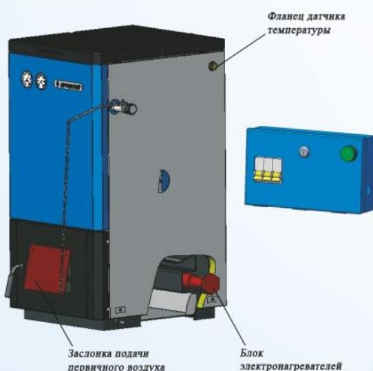
Фланец блока тэнов 2" находится в нижней точке котла. В верхней точке котла, в районе патрубка подачи воды, находится фланец датчика температуры 1/2" для установки в него гильзы терморегулятора.
