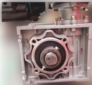
6. Правильно установленный предохранительный болт.
